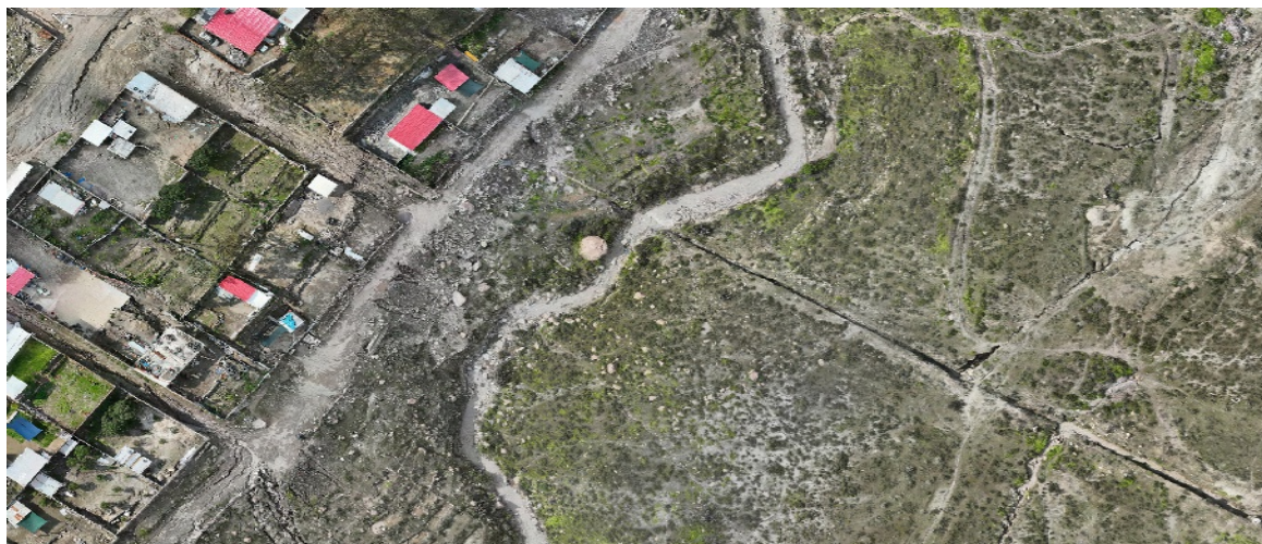
IMAGEN 03: SE MUESTRA LA QUEBRADA PASTO RAIZ COLMATADA CON FALTA DE VEGETACION PARA ESTABILIZACION DE TALUDES
