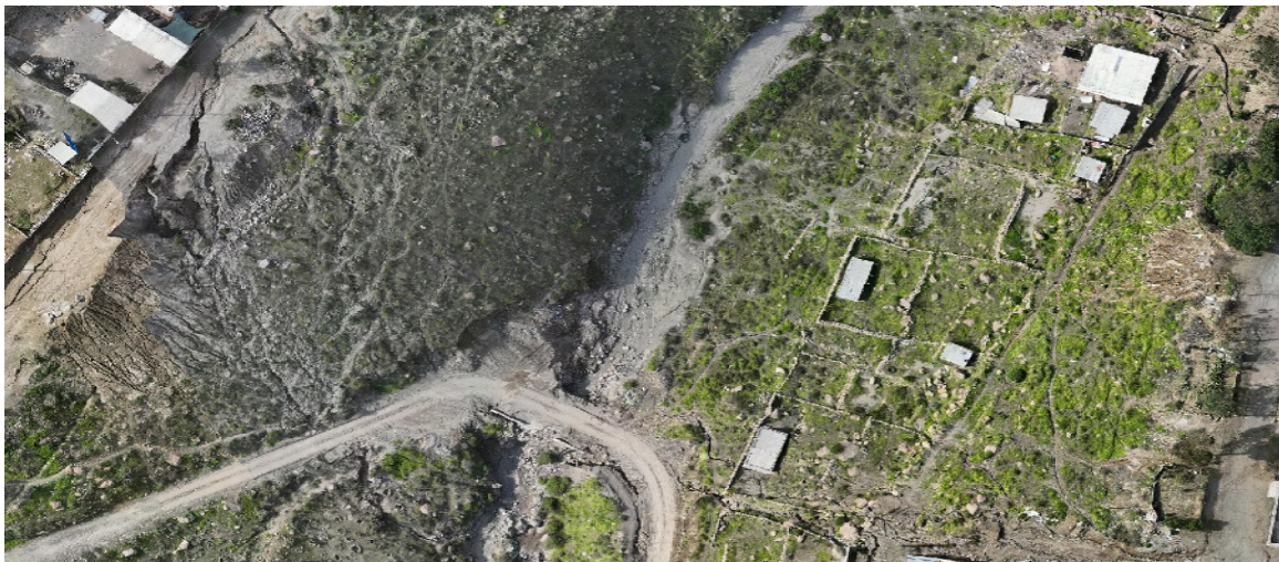
IMAGEN 02: SE MUESTRA LA QUEBRADA PASTO RAIZ, EN EL CAUCE PASA LA VIA OBSTRUYENDO EL PASO NATURAL DEL AGUA SE REQUIERE DESCOLMATACION
